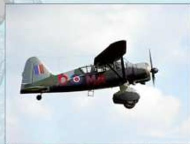
Le Lysander fut le seul appareil utilisé pour les atterrissages clandestins. C'était un monomoteur - monoplan, conçu comme avion d'appui à l'armée de terre, il fut utilisé pour atterrir sur des terrains de fortune.
